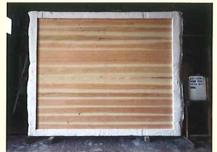
〈スギ板仕上げの準耐火構造外壁試験体〉
